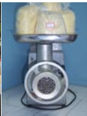
Máquina para peletização da ração.
